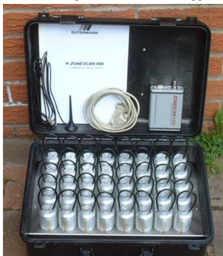
Figura 5 e 6. Noise Loggers e loro installazione
