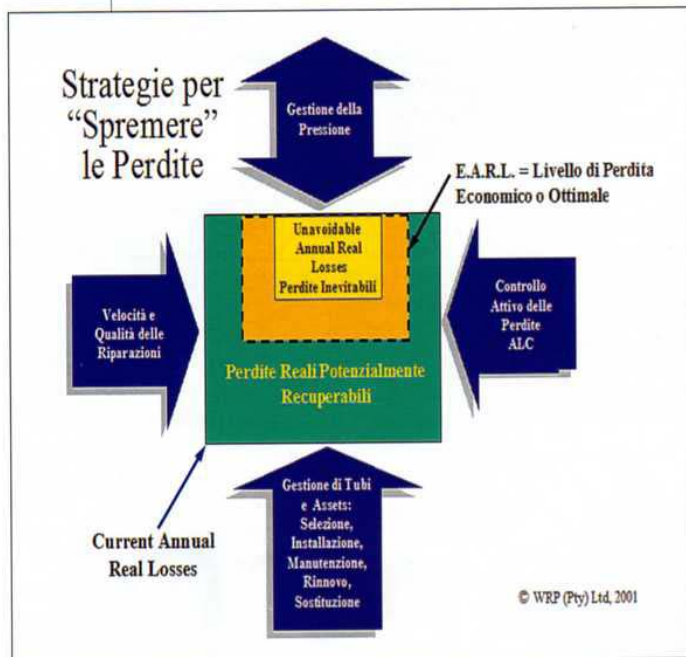
FIGURA 6: GESTIONE PRATICA DELLE PERDITE REALI MEDIANTE IL METODO A 4 COMPONENTI.
